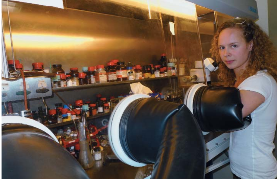
Abb. 7 Arbeiten unter Ausschluss von Sauerstoff und Feuchtigkeit an einer Glove-Box
