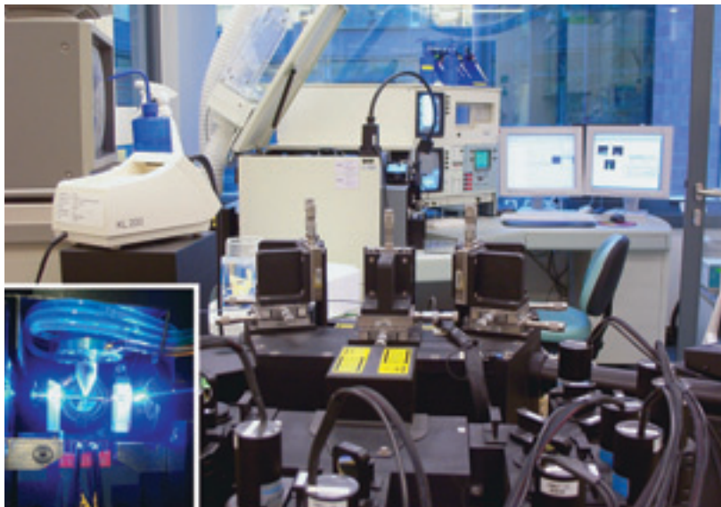
Abb. 5 Hochgeschwindigkeits-Zellsorter für die Trennung von Zellen und die fluoreszenz-zytometrische Multiparameteranalyse an Blutzellen.
