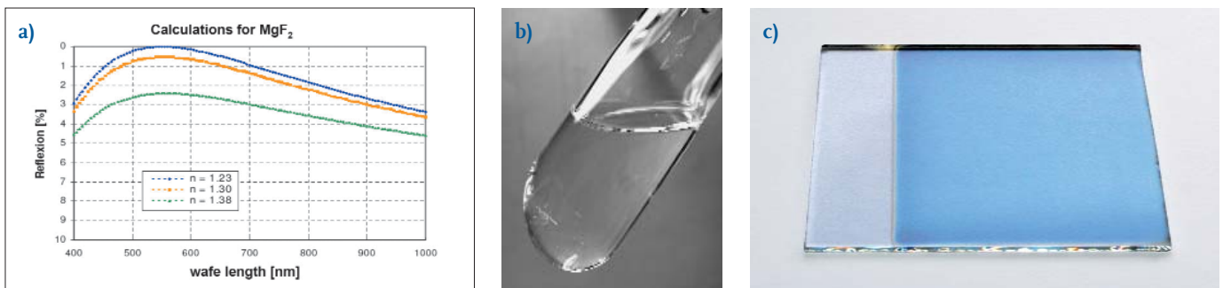
Abb. 2 a) Theoretische Reflexion in Abhängigkeit vom Brechungsindex der Schicht; b) Transparentes \text{MgF}_2 -Sol (Teilchendurchmesser 4 bis 9 nm); c) Harte, transparente \text{MgF}_2 -Schicht auf Borsilicatglas.
