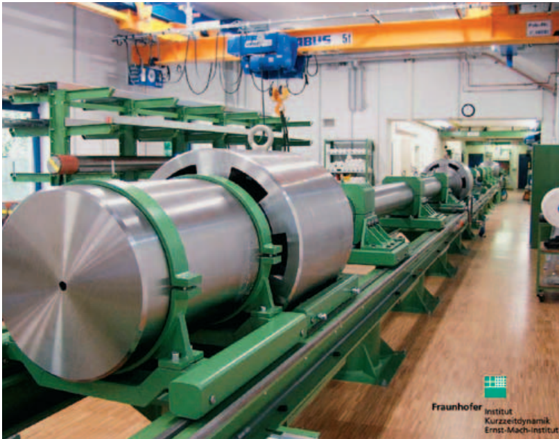
Abb. 3 In dieser zweistufigen Leichtgas-Beschleuniger wurden die Meteoriten auf 20.000 Stundenkilometer beschleunigt. (Quelle: EMI-Freiburg)
