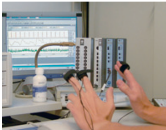
Abb. 1 Messapparatur Biopac mit Sensoren zur Aufnahme des Hautleitwertes und des Plethysmogramms
