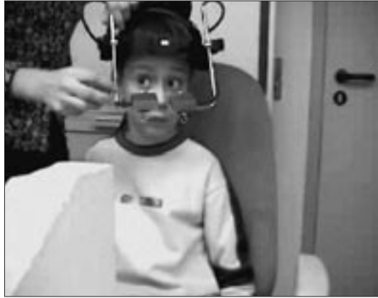
Abb. 3 Anpassung der Messeinrichtung zur Bestimmung der Blickrichtung
