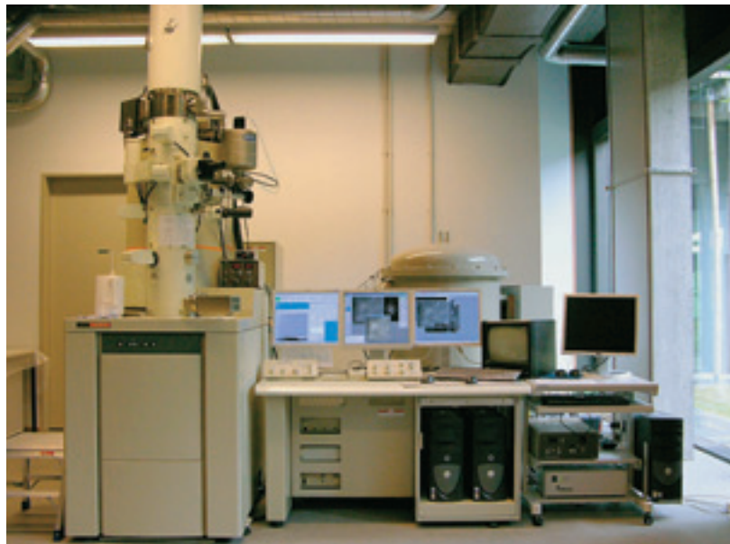
Abb. 4 Das neueste hochauflösende 200kV-Transmissionselektronenmikroskop vom Typ JEOL JEM2200FS in der Arbeitsgruppe Kristallographie (Leitung: Prof. W. Neumann), mit dem zum Beispiel die atomare Struktur eines ZnTe-Nanodrahtes abgebildet werden kann (unten). An diesem leistungsfähigen Analysegerät führen auch andere Adlershofer Institute wie das Leibniz-Institut für Kristallzüchtung und das Ferdinand-Braun-Institut für Höchstfrequenztechnik Untersuchungen zur strukturellen und chemischen Charakterisierung von nanostrukturierteren Materialien durch.
