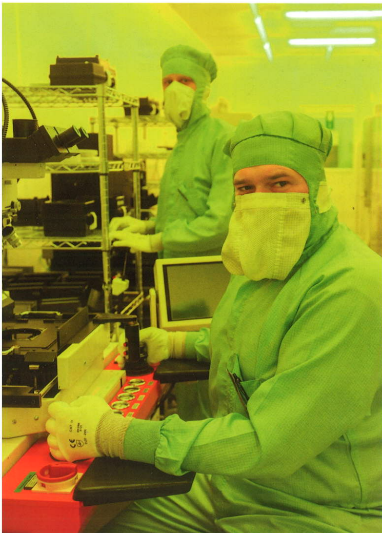
Dominik Sudau (r.) im Reinraum – hier arbeitet er am Mask Aligner. Die Belichtung ist einer der ersten Arbeitsschritte auf dem Weg zum fertigen Mikrochip.
