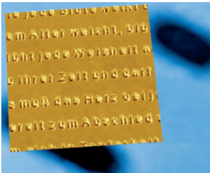
Abb. 3 Ein Gedicht von Hermann Hesse, geschrieben in ein Polymer mit der Spitze eines Kraftfeldmikroskops (siehe dazu den Beitrag von K. Rademann / C. Ritter: Friction on the Nanometer-Scale )
